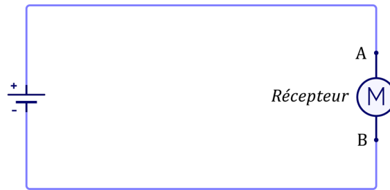
Figure 2.9 – Circuit dans lequel le récepteur est un moteur électrique.
